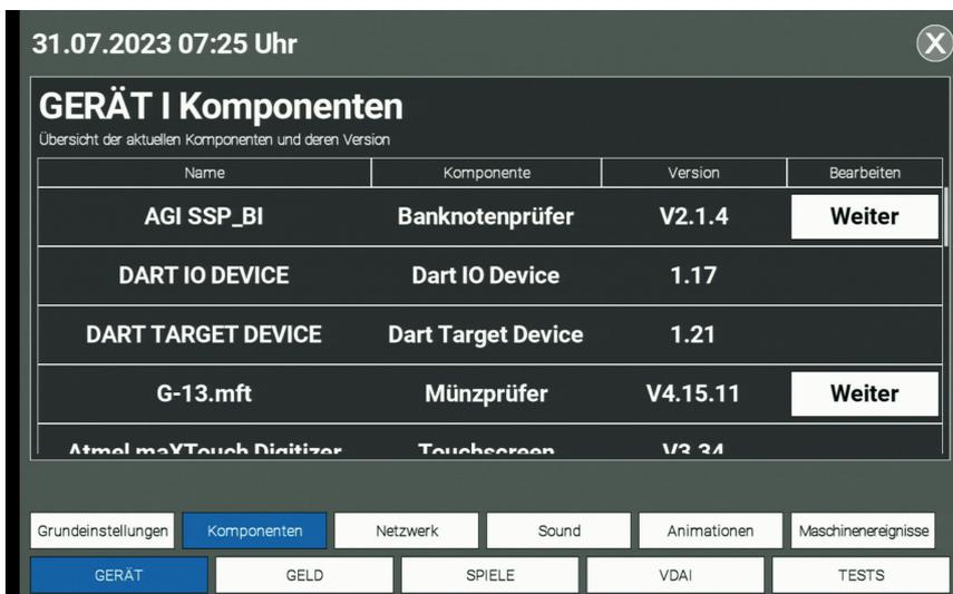
In diesem Menü (z.B. Banknotenprüfer) ist es möglich die Komponenten zu aktivieren bzw. deaktivieren. In diesem Menü können Sie auch direkt in den Testmodus der Komponente springen siehe „11. Tests“ auf Seite 66).
