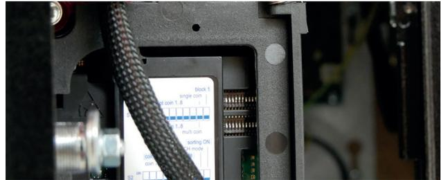
3. Setzen Sie alle DIL-Schalter 1–10 des unteren Schalterblocks (S2) nach unten auf OFF. Der obere Schalterblock (S1) ist beispielhaft und kann variieren. Notieren Sie sich die Schalterstellung des oberen Schalterblocks (S1) und stellen alle auf OFF.
