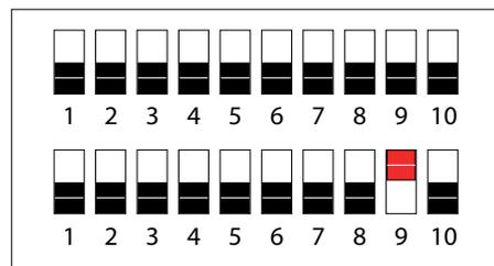
5. Setzen Sie den DIL-Schalter des anzulernenden Münzkanals S1.7 oder S1.8 nach oben auf ON. Beispiel: Im Beispiel wird S1.7 nach oben auf ON gesetzt.
