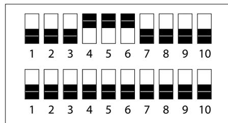
4. Setzen Sie den DIL-Schalter 9 des unteren Schalterblocks S2.9 nach oben auf ON. Das Gerät befindet sich zum Anlernen der Münzkanäle im Teach-Mode.
