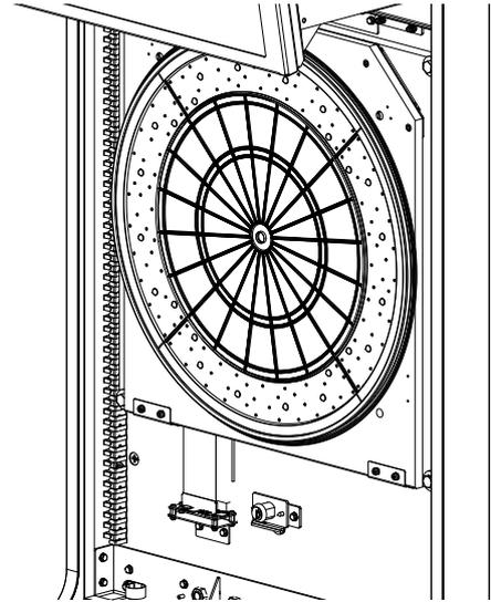
4. Sofern auf der Schaltmatrix keine Markierungen vorhanden sind, markieren Sie die Position der Aussparungen der Gummimatte mit einem wasserfesten Stift.
