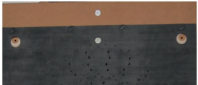
6. Positionieren Sie die neue Gummimatte, sodass die Aussparungen mit der Markierung fluchten und befestigen die Gummimatte am oberen Rand mit neuen Klammern.
